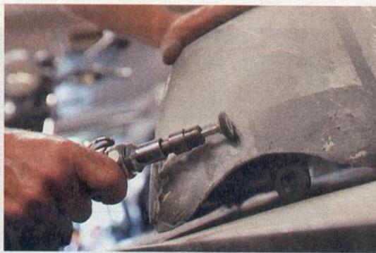
**Immer an dem Rand entlang. Später wird der Tank mit Kaltmetall abgedichtet**
